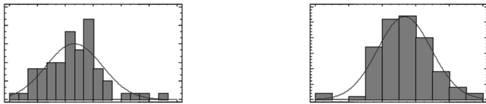
Figure 2 : Histogrammes des températures moyennes dans le réfrigérateur. A gauche : saumon fumé (2 e campagne de mesures). A droite : plats préparés (4 e campagne de mesures)
